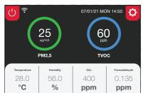
\*PM1 : 0.3 μm - 1 μm \*PM2.5 : 0.3 µm - 2.5 µm \*PM10 : 0.3 µm - 10 µm
